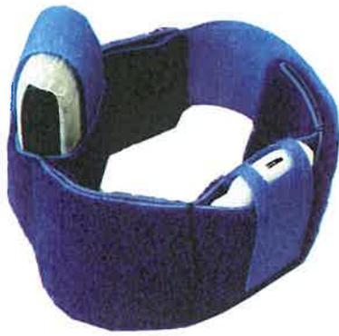
Abbildung 1.1.: Sensorbandage mit GPS Logger und Akzelerometer
