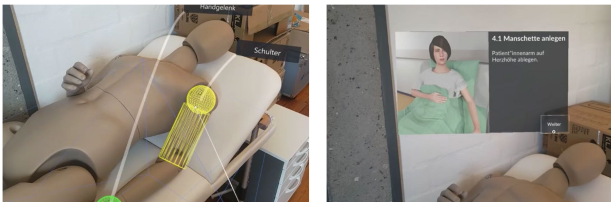
Abbildung 16: Rechts: Kalibrierung des AR-Sichtsystems durch manuelle Überlagerung virtueller Referenzobjekte mit ihren realen Entsprechungen durch Platzierung einer gelben Kugel mit gelbem Zylinder an der Position des Schultergelenks. Rechts: Anzeige des aktuell auszuführenden Arbeitsschrittes auf einer im Raum „schwebenden“, virtuellen Anzeigetafel.
