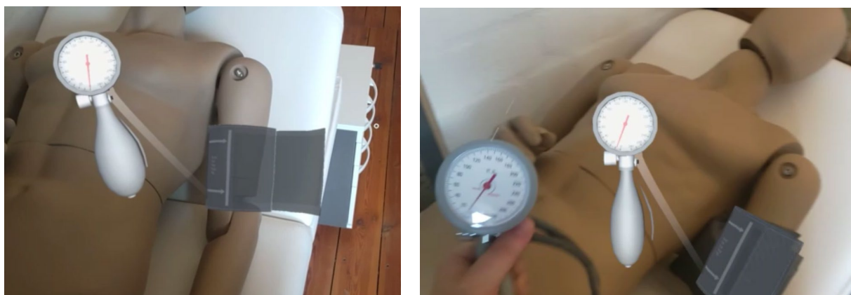
Abbildung 17: Links: Virtuelle Demonstration des Anlegens einer Blutdruckmanschette durch Platzierung der virtuellen, animierten Geometrie unmittelbar am realen Objekt (hier dem linken Arm der Puppe). Rechts: Messung des Blutdrucks mit realem Blutdruckmessgerät parallel zur virtuellen Demonstration. Die Beobachtung der virtuellen Anzeige erlaubt einen direkten Soll-Ist-Abgleich.
