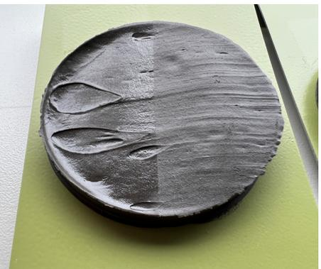
**Abbildung 19: Detailansicht der Dichtmasse nach 5x Vernebelung**
